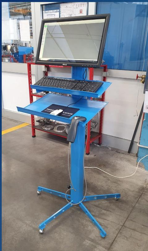
Implementazione di postazioni totem bordo macchina: progettata per migliorare l'efficienza, la sicurezza e la gestione della produzione nelle operazioni di lavorazione CNC, fornendo agli operatori strumenti e informazioni utili direttamente vicino alla macchina.
